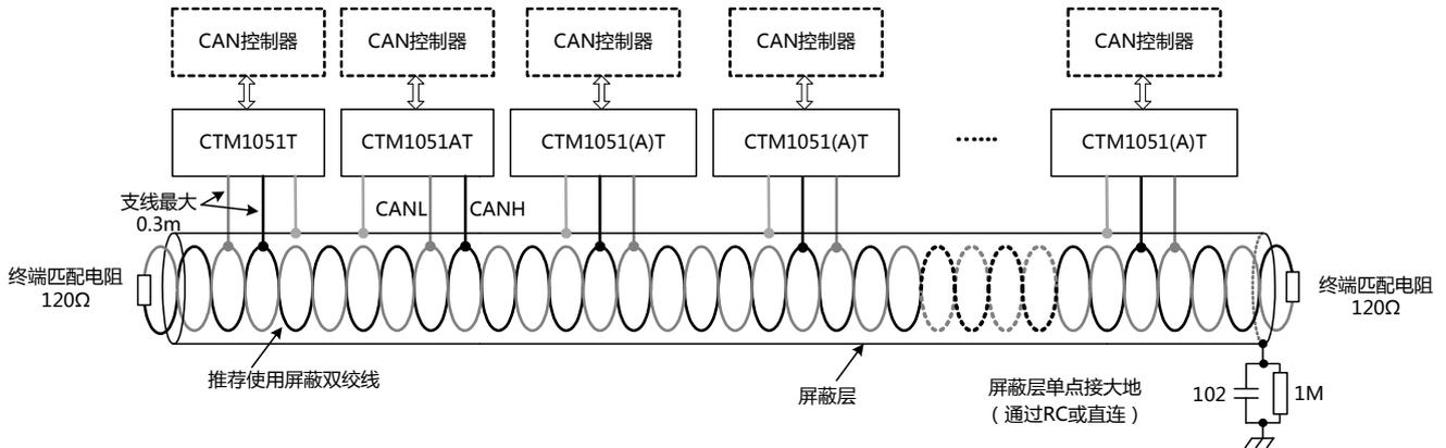
图 3. 单个CAN-Bus典型网络连接示意图
