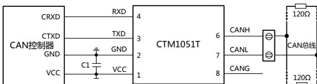
图 1. CAN控制器 5V供电应用电路
