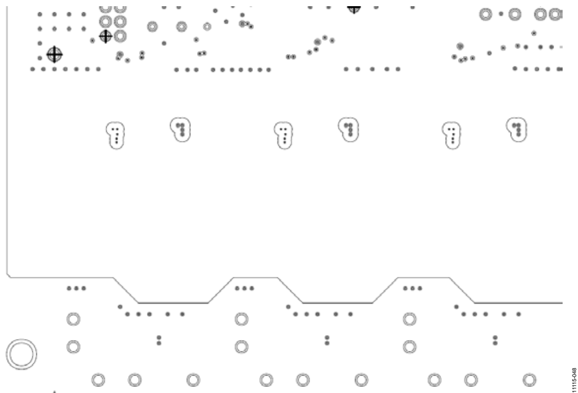
图60. 4层电路板：第2层
