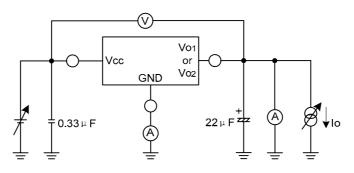
■ TEST CIRCUIT FOR RIPPLE REJECTION RATIO
