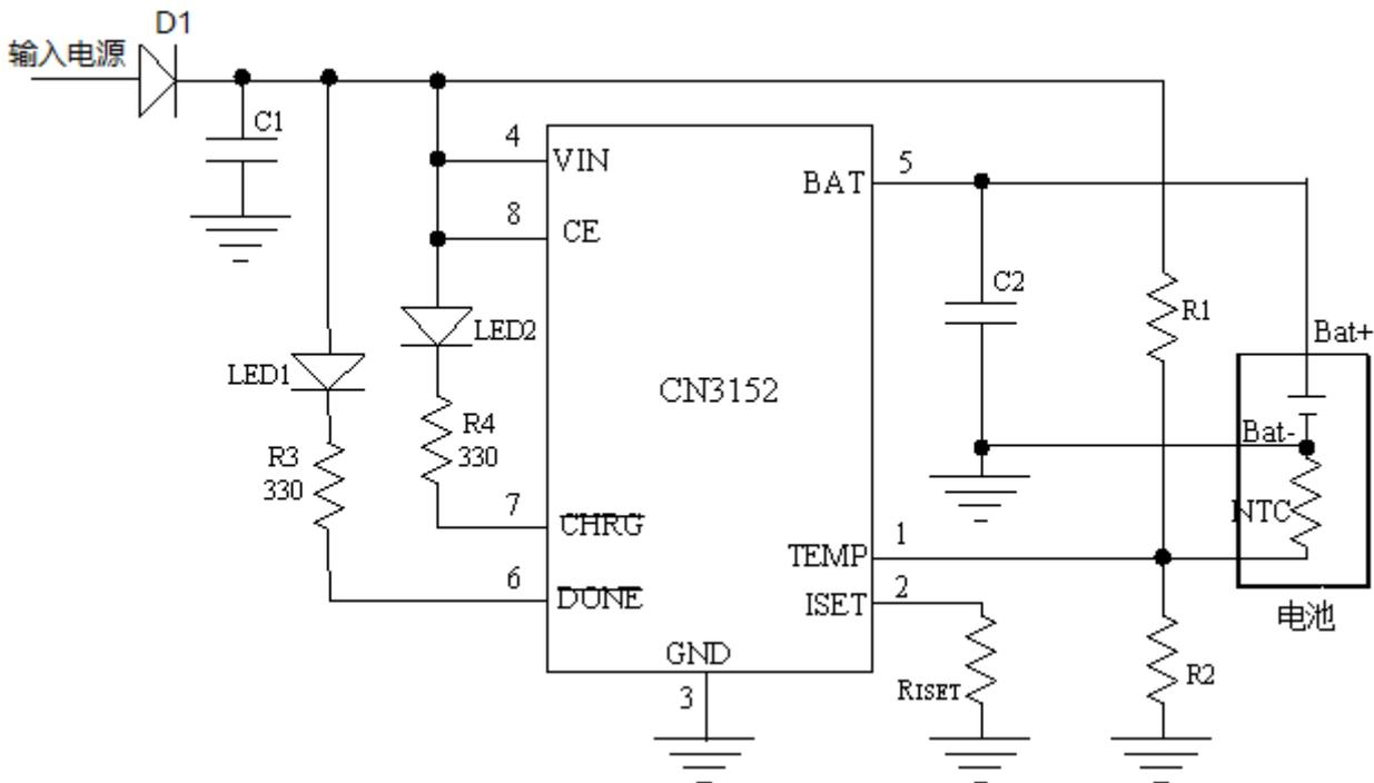
图4 增加二极管抑制过冲电压
