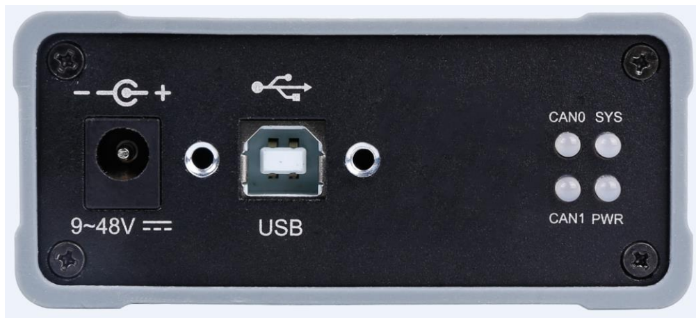
图 2.1 USBCANFD-200U 左端接口
