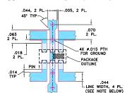
IES: 1.TRACE WIDTH IS SHOWN FOR ROGERS RO4350B WITH DIELECTRIC THICKNESS 0.020" ± 0.0015"; COPPER: 1/2 OZ. EACH SIDE. FOR OTHER MATERIALS TRACE WIDTH MAY NEED TO BE MODIFIED. 2.BOTTOM SIDE OF THE PCB IS CONTINUOUS GROUND PLANE.
