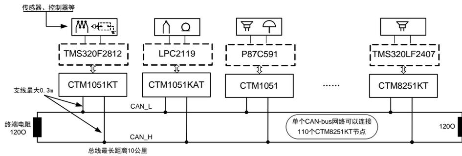
图 2 单个 CAN-bus 典型网络连接示意图
