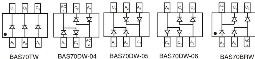
**200mW, 70Volt Schottky Barrier Diode**
