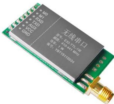
E32-TTL-1W 是一款基于 SEMTECH 公司 SX1278 射频芯片的无线串口模块 (UART)，透明传输方式，1W 发射功率，工作在 410~441MHz 频段 (默认 433MHz)，LoRa 扩频技术，TTL 电平输出，兼容 3.3V 与 5V 的 IO 口电压。
