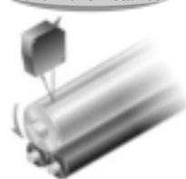
Rilevamento eccentricità di un rullo metallico
