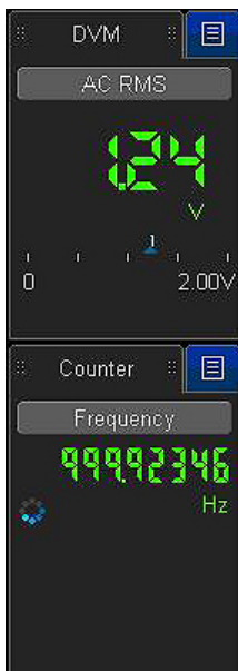
그림 26: DVM 및 카운터는 별도의 신호 경로를 활용하여 기준과 같이 오실로스코프 프로브를 이용해 트리거 없이 측정을 수행할 수 있도록 지원합니다.
