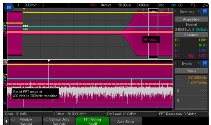
그림 21d: 검색 lister 디스플레이에 표시되어 있듯이 RF 신호는 200 MHz에서 안정적으로 유지됩니다.
